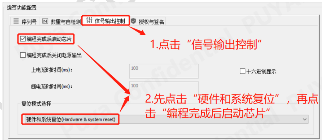
图 12-3 创芯工坊操作勾选“编程后重启芯片”
